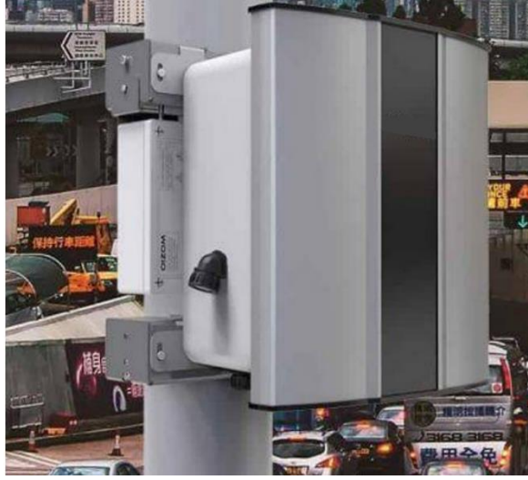
Şekil 1. Direklere asılabilen ölçüm istasyonları [1]
